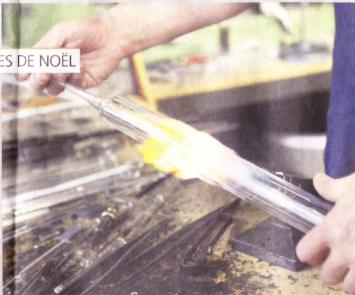
Des tubes de verre borosilicate sont utilisés pour réaliser les objets.
