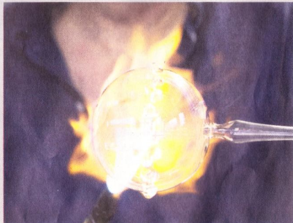
Le verre se retrouve dans une flamme qui atteint 2700 degrés!
