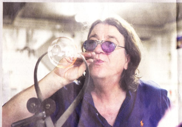
Puis Claude Merkli souffle l'objet dans un gabarit afin que le tube devienne boule.
