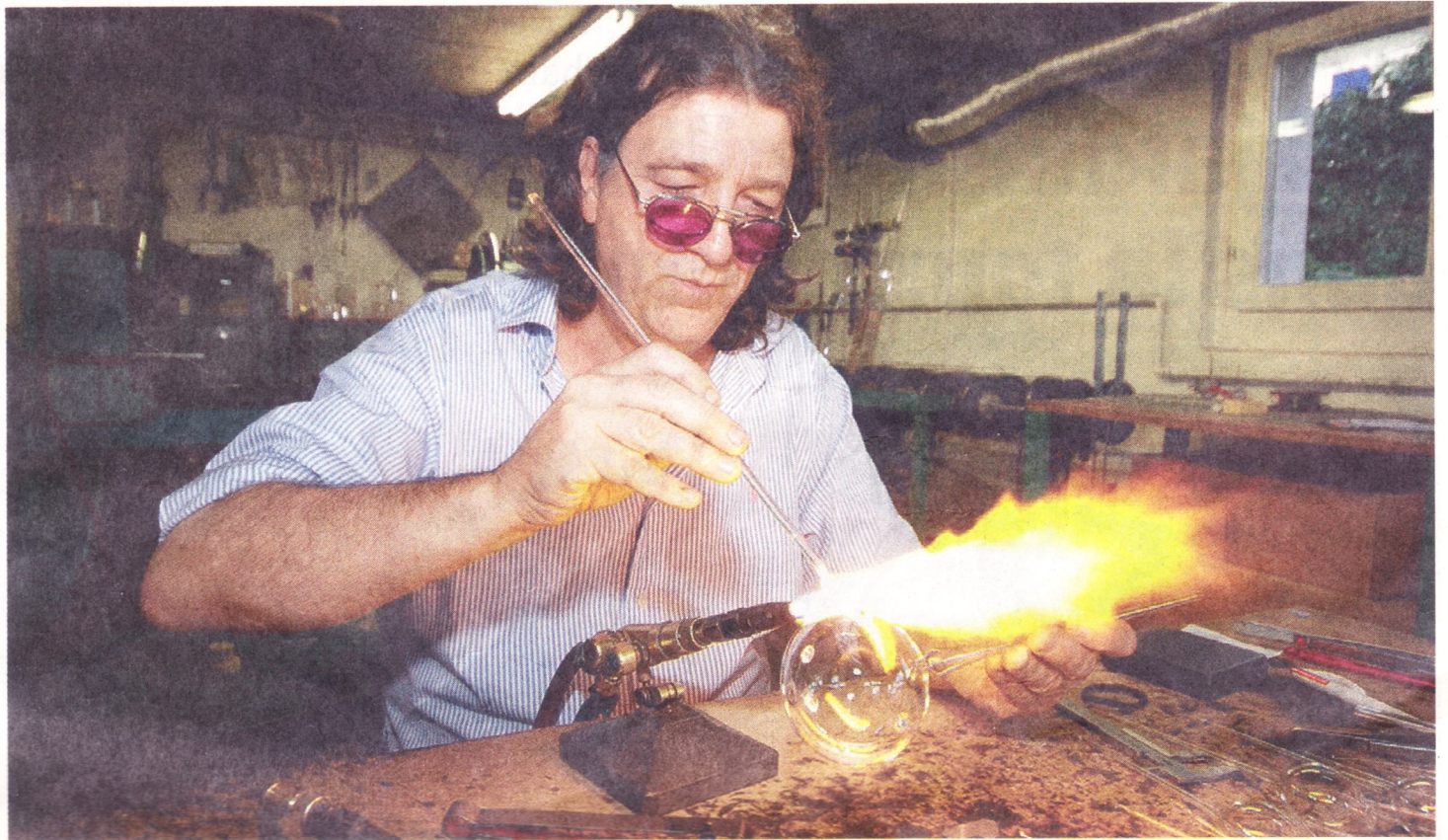
L'artisan utilise la technique du soufflage de verre au chalumeau. Aujourd'hui, le temps est à la confection des boules de Noël. SAMUEL FROMHOLD
