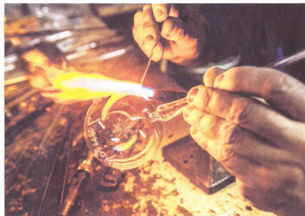
Après avoir étiré un tube de verre dans la flamme de son chalumeau (en bas à gauche), Claude Merkli souffle l'objet dans un gabarit (en haut). Il y grave le prénom avec une tige de 2 mm de diamètre (en bas, au milieu). Dans sa boutique, nombre de modèles sont suspendus, avec d'autres articles de décoration.
